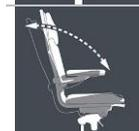
Kniematic-Wippmechanik, Federkraft individuell auf das Körpergewicht einstellbar, mehrfach arretierbar
