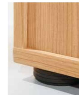
**Stellfuß** Standardmäßig mit 4 Kunststoffboden- gleitern, 25 mm hoch, Ø 80 mm, von innen durch den Schrankboden höhenjustierbar (+ 10 mm).
