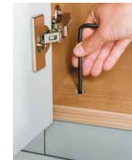
**Stahlsockel**, H = 68 mm optional erhältlich 4-seitig umlaufend, einbrennlackiert, ähnlich RAL 9006 (graualuminium). Von innen durch den Schrankboden höhenjustierbar (+20 mm). Rücksprung zur Korpusvorderkante = 10 mm, Rücksprung zur Korpusrückkante = 22 mm.
